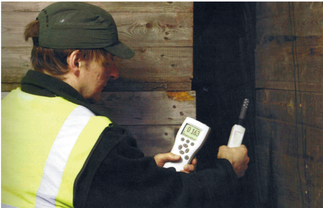
Рис. 7.2 Прибор для измерения углекислого газа
